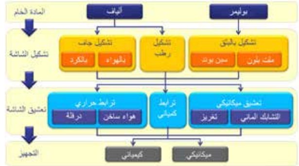
نظرة عامة عن تكنولوجيا تصنيع الأقمشة غير المنسوجة المختلفة (المصدر: معهد الأقمشة غير المنسوجة)
