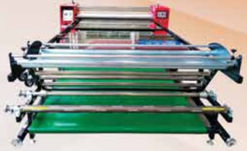
ماكينة حراري Roll To Roll TRA-JET لكبس ورق السابلميشن على خامات البوليمستر
