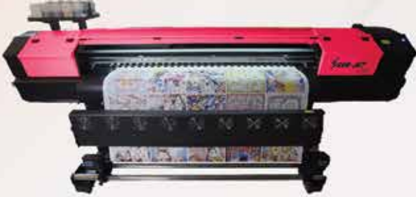
ماكينة SUB-JET DUA لطباعة ورق السابلميشن للكبس على أقمشة البوليمستر عرض ١٨٠ سم 2 Epson 5113 heads
